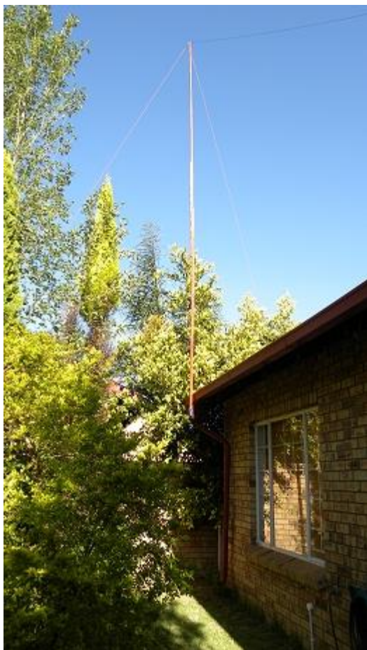
11 m Band "Zepp" (EDZ) Antenna: palo di legno (clicca sull'immagine per una versione più grande)
