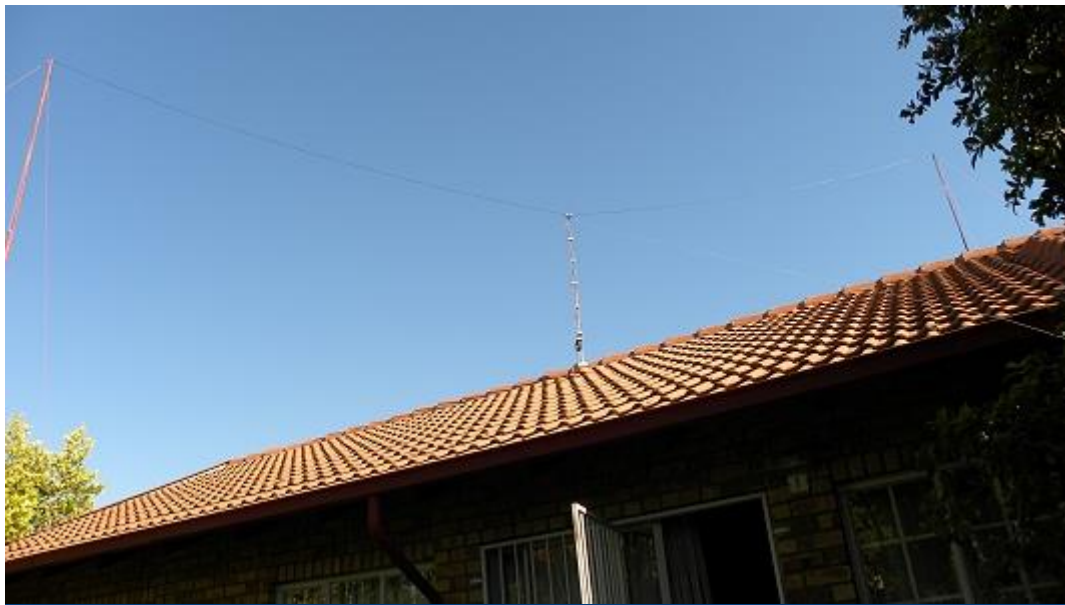
Antenna 11 m Band "Zepp" (EDZ) centrata a 27.500 MHz (clicca sull'immagine per una versione più grande)
