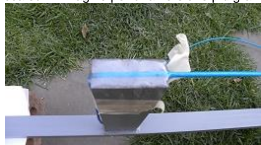
11 m Banda J-Pole antenna: inferiore puntone (filo incollato sul posto) (clicca sull'immagine per una versione più grande)
