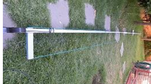
11 m Banda J-Pole antenna: Pronto per l'installazione
