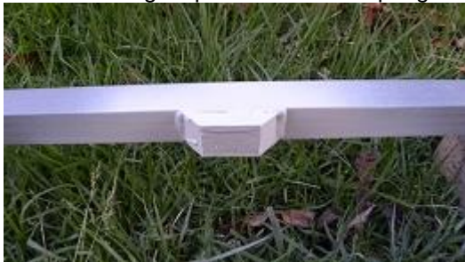
11 m Banda J-Pole antenna: Spacer (clicca sull'immagine per una versione più grande)
