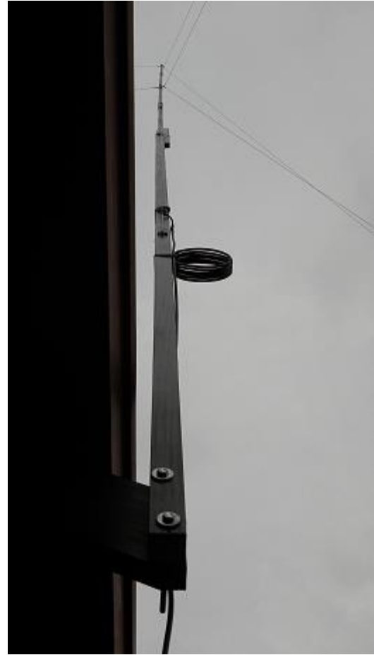
11 m Banda J-Pole antenna: Vista laterale (clicca sull'immagine per una versione più grande)
