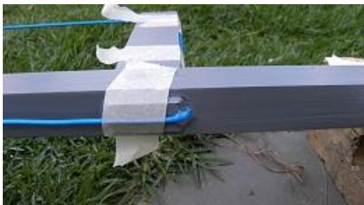
11 m Banda J-Pole antenna: Hole in albero per filo antenna (lato lungo) (clicca sull'immagine per una versione più grande)
