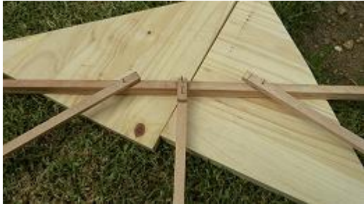
11 m Banda Hentenna: Centro incollato sul posto (clicca sull'immagine per una versione più grande)
