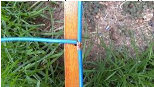
11 m Banda Hentenna: collegamento alimentatore temporanea (clicca sull'immagine per una versione più grande)
