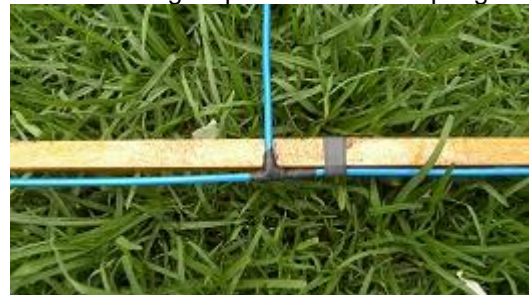
11 m Banda Hentenna: Saldato collegamento alimentatore registrato (clicca sull'immagine per una versione più grande)
