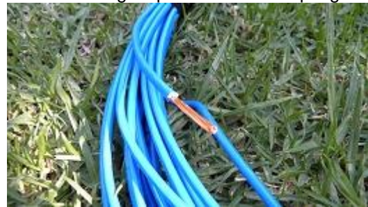
11 m Banda Hentenna: filo di rame isolato PVC (clicca sull'immagine per una versione più grande)
