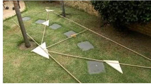
11 m Banda Hentenna: Completamente assemblato (clicca sull'immagine per una versione più grande)
